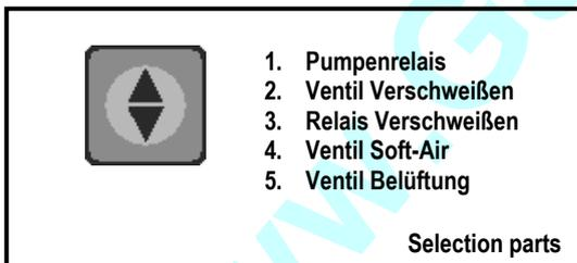
5. Wählen Sie durch Drücken der Taste FUNKTIONSAUSWAHL die Nummer der Komponente, für welche die Erkennung erfolgen soll. Vgl. die Liste der Komponenten-Nummern in der Übersicht. Bitte beachten Sie, dass die Komponenten Nummer 5 und 6 jeweils maximal 3 Sekunden lang aktiviert werden dürfen! Eine längere Aktivierung führt zu Verbrennungen auf der Schweißleiste oder auf sonstigen wichtigen Komponenten.
