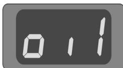
Nach Ablauf des eingestellten Zeitraums erscheint auf dem Steuerungsfeld die Meldung { OIL }. Das bedeutet, dass das Wartungsintervall abgelaufen ist und nun die Wartung erfolgen sollte. Die Meldung verschwindet nach 3 Sekunden, und das Gerät kann normal eingesetzt werden. Die Meldung erscheint jedoch bei jedem Einschalten des Geräts erneut.
